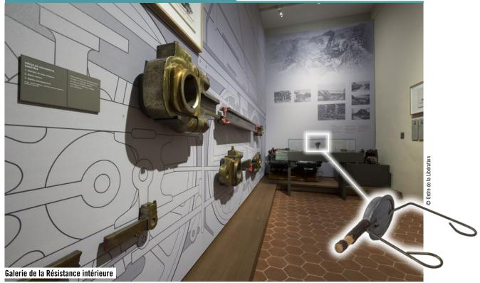
Le « signal de brume » est une partie du dispositif servant à déclencher une explosion. Ce signal est placé sur le rail et relié par une mèche à un explosif. Au passage du train, il est écrasé et déclenche l'explosion.
